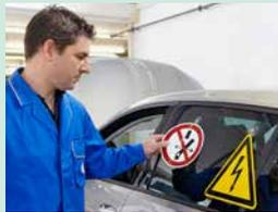
Fahrzeug kennzeichnen, Warnschilder anbringen und nach Möglichkeit Absperrung anbringen.
