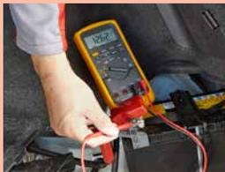
Messgerät an 12V-Batterie prüfen (Punkt 1 der 3-Punkte-Regel).
