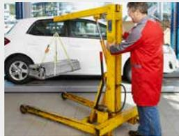
Für Ausbau geeignete Sicherungs- und Hubvorrichtungen verwenden (Ergonomie!).
