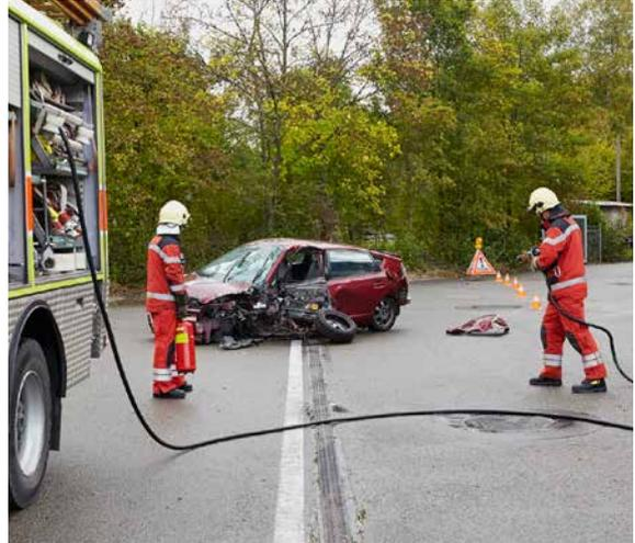
Von Unfallfahrzeugen mit Hochvoltssystemen gehen verschiedene Gefährdungen aus, z.B. Störlichtbögen, Brandgefahr durch Auslaufen brennbarer Flüssigkeiten oder Vergiftungen durch Einatmen toxischer Substanzen.
