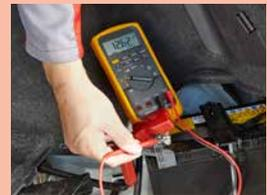
Messgerät erneut an 12V-Batterie prüfen (Punkt 3 der 3-Punkte-Regel).
