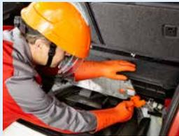
Servicestecker von Energieträger abziehen. Isolierhand-
