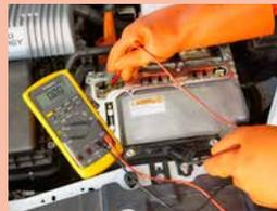
Spannungsfreiheit prüfen (Punkt 2 der 3-Punkte-Regel).
