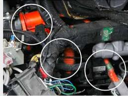
Orange Stecker oder Kabel, erkennbare Fahrzeugbeschriftungen sowie Ladestecker weisen auf ein Elektro- oder Hybridfahrzeug hin.
