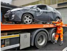
Fahrzeug mit Plateauwagen transportieren (nicht abschleppen). Fahrzeug sichern.
