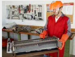
Energiespeichereinheiten soweit als möglich separieren, um das Energiepotenzial zu reduzieren. Reparatur oder Austausch defekter Speichereinheiten.
