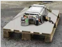
Hochvoltbatterien für Transport auf einer isolierenden Auflage platzieren und sichern.
